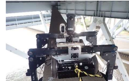
トラス橋 ラテラル走行ロボットとの併用
