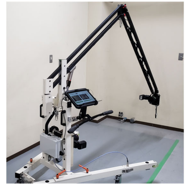
図2 壁高欄測定ロボット
