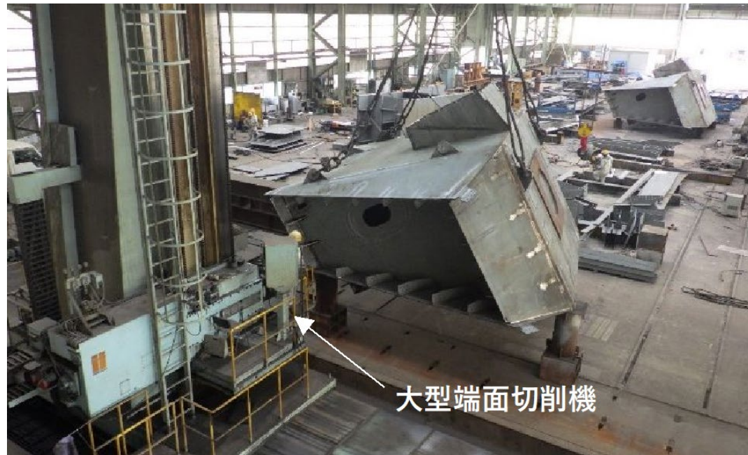
【ブロック端面切削状況】
