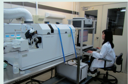
重金属分析のための ICP-MS (誘導結合プラズマ質量分析計) 装置
