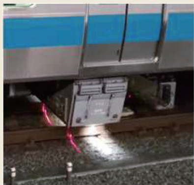
線路設備モニタリング装置
