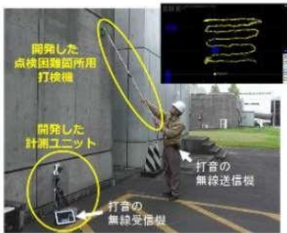
図 4.2.7 高所打検機（コンポーネント組合せ）
