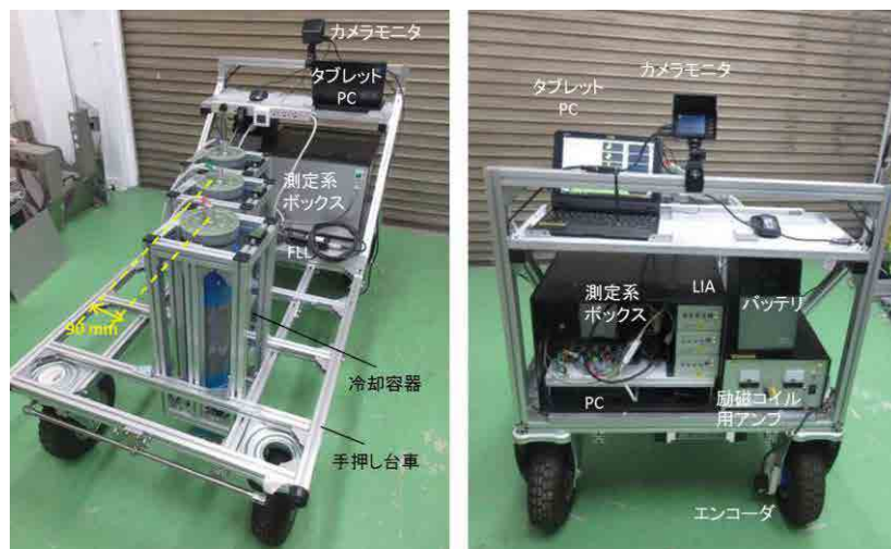
図 2.4.9 開発した路上試験用 3 ch プロトタイプ検査装置
