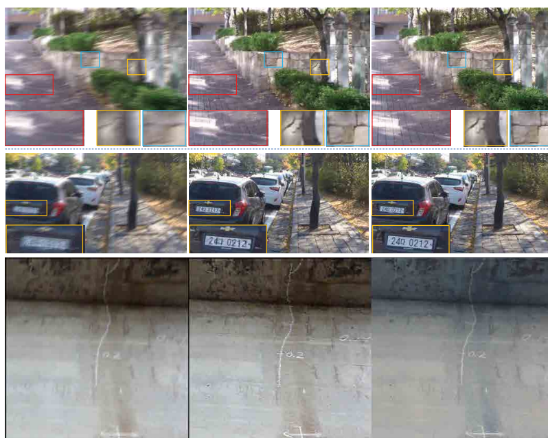
図 2.1.4 単一画像からのモーションブラーの補正例. 左列から入力画像（ブラーあり）、モーションブラー補正画像、正解画像. 上2つはGoPro データセット、下は道路橋コンクリート表面の画像
