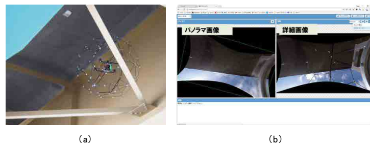
図 2.1.1 「橋梁の打音検査ならびに近接目視を代替する飛行ロボットシステムの研究開発」の概要 (a)受動回転球殻機構を持つマルチコプタ（球殻ヘリ） (b)点検支援ソフトウェア
