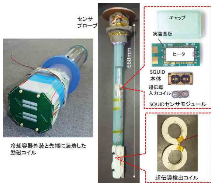
図 2.4.2 SQUID を用いた磁気センサ部
