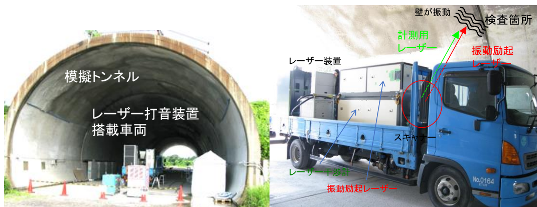
図 3.2.3 (a)模擬トンネルにおける設置状況 (b)レーザー打音高速装置搭載車両
