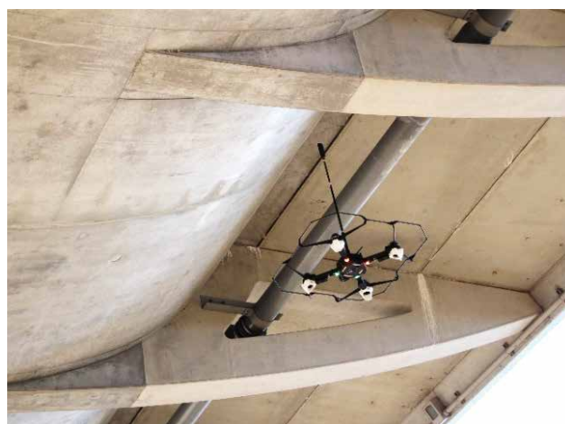
図-4 360度カメラを装着したドローン
