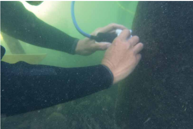
図-3 極低周波渦電流検査装置による計測
