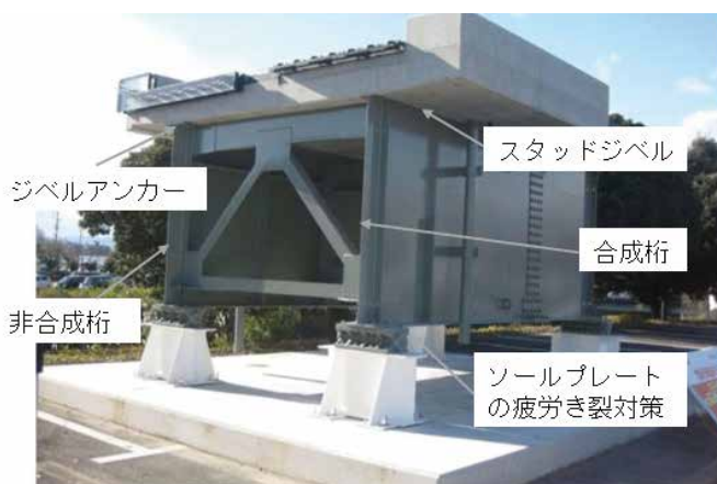
図-5 鋼桁モデルの外観
