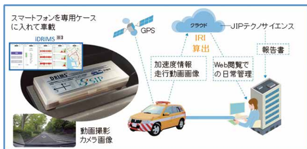
図-6 スマートフォンを利用した路面性状調査の仕組み(資料:JIPテクノサイエンス株式会社)
