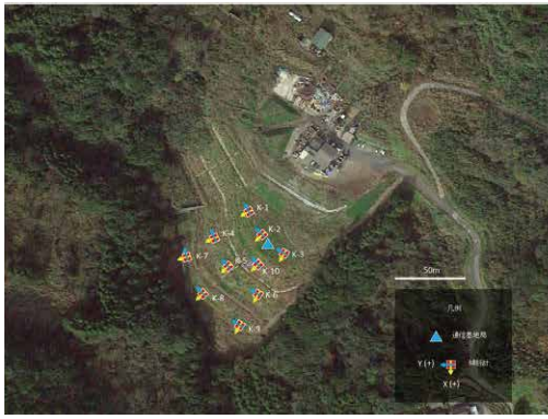
図-3 センサ敷設位置と傾斜計の方向
