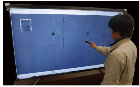
図-7 大型タッチパネルによるバーチャル近接目視点検
