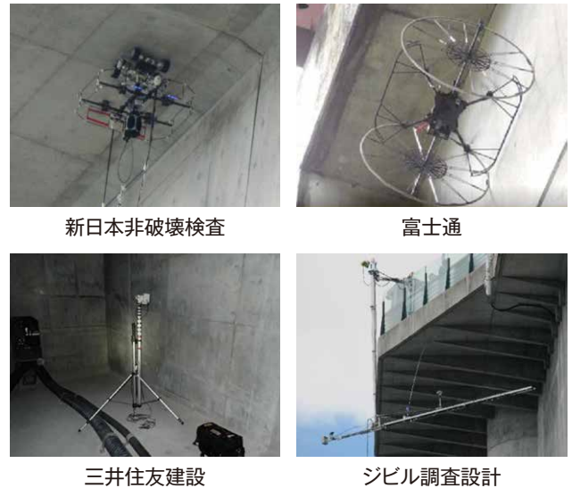
図-5 実証試験に用いたロボット技術
