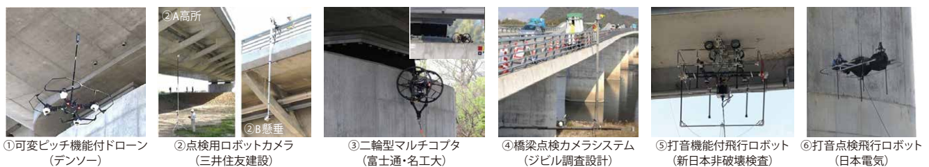
図-4 活用する橋梁点検技術
