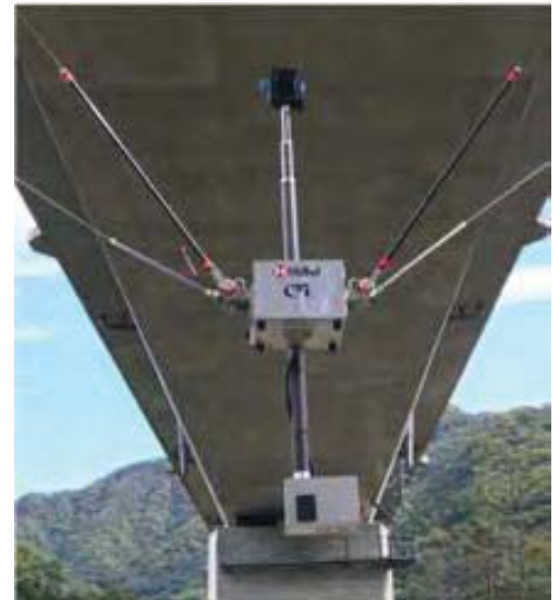
ハイボット：ワイヤとロッドを用いた橋梁点検システム SIPインフラ（～2018年度）
