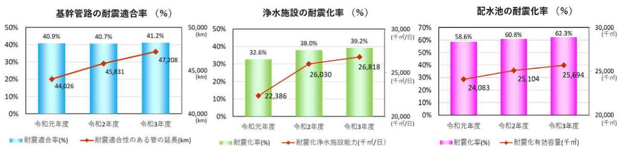
図 8 水道施設（基幹管路、浄水施設、配水池）の耐震化状況
