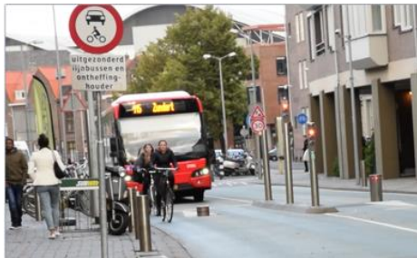
図 3-2-3 補助幹線道路にライジングボラードを設置 64) (オランダ・ブレダ、18 万人)
