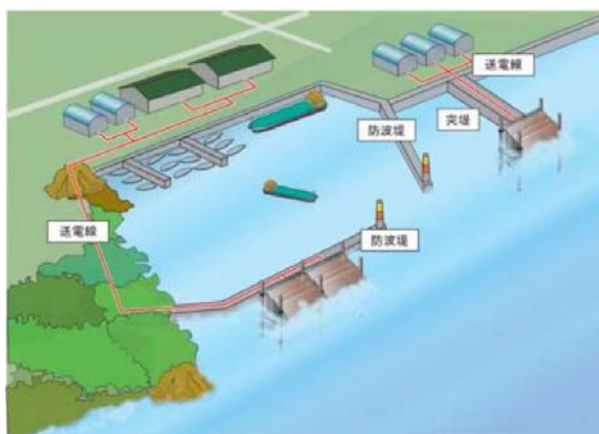
越波式波力発電装置の鳥瞰図
