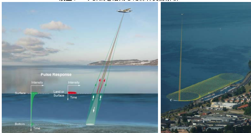
航空レーザ測深の計測概念
