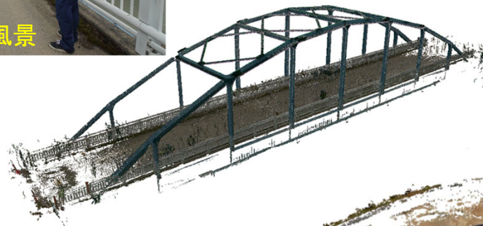
トラス上部構造の点群モデル
