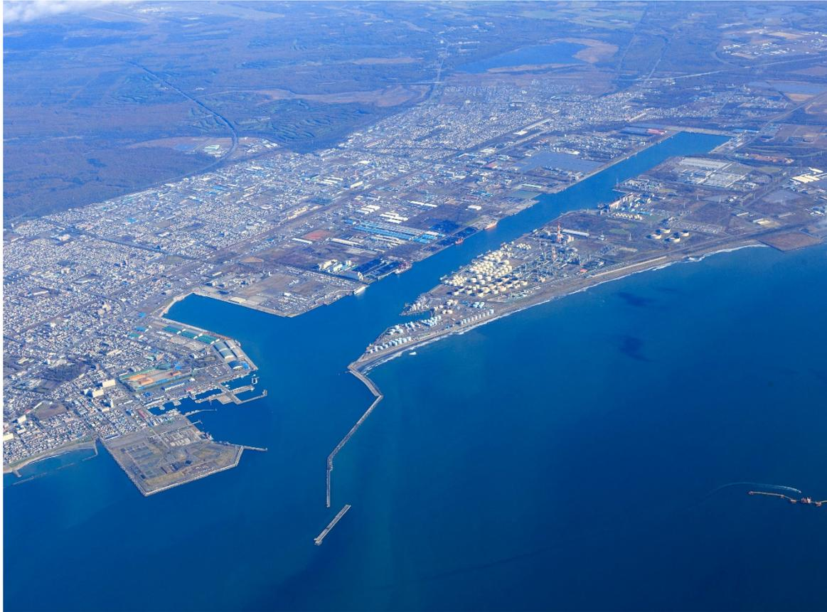
苫小牧港大規模掘込港湾施設は、漂砂対策に基づく防波堤と長大な水路からなる世界初の掘込式港湾を砂浜と原野に築き、新たな臨海工業地帯の開発を実現した施設です。
